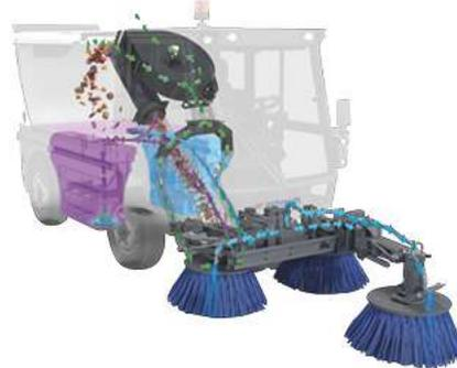
Le système à 3 balais avec un balai frontal orientable offre une largeur de balayage jusqu'à 2600 mm. Le balai frontal se déplace en translation et pivote de droite à gauche avec la possibilité d'un balayage sur deux niveaux ou d'une utilisation d'un balai de désherbage.
