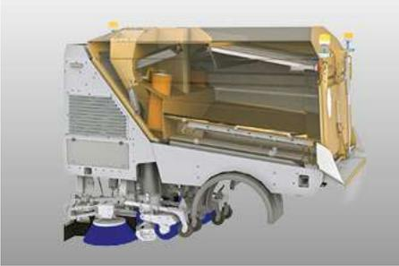
Les 7 m<sup>3</sup> de capacité de la cuve à déchets permettent de collecter de grande quantité de déchets. L'acier inoxydable du fond de cuve et les rideaux déflexeurs en caoutchouc garantissent une longue durée de vie et quasiment aucune usure.
