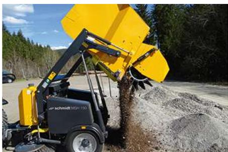
La gamme des balayeuses remorquées MSH dispose d'une cuve à déchets de construction mécanosoudée acier d'une capacité de 0,7 m<sup>3</sup> et d'une hauteur de déchargement de 1 500 mm pour la version MSH 070 et de 1,5 m<sup>3</sup> et d'une hauteur de déchargement de 1 800 mm pour la MSH 150. Dans chaque cas, le déchargement s'opère vers l'arrière de la balayeuse avec possibilité de vidage dans des containers.
