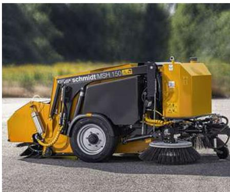
La MSH 150 dispose d'une cuve à déchets d'une capacité de 1,5 m<sup>3</sup>
